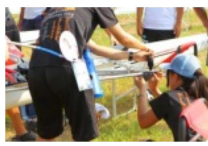
自分たちが使用するためにボートの各部調節をします。これをリギング(写真)と言います。
